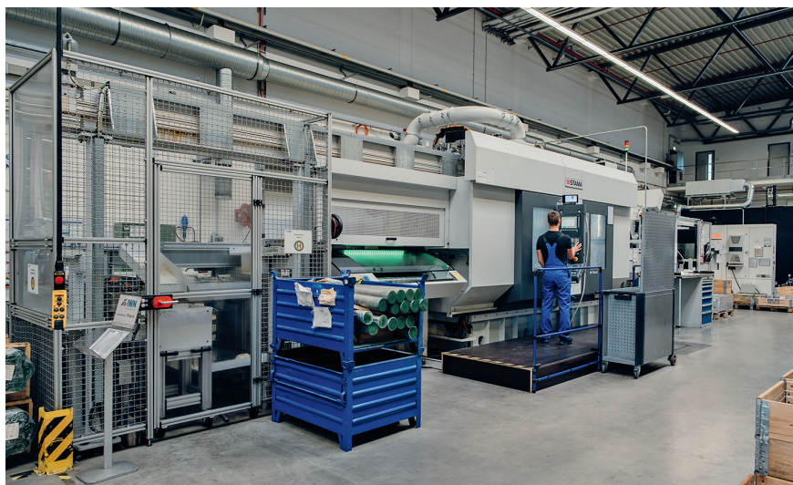
2 Mit dem 5-Achs-Fräsdrehzentrum MT 734 2C von Stama gelang IWN im Jahr 2017 der Einstieg in die Komplettbearbeitung für komplexe Werkstücke mit hohem Fräsanteil © IWN
